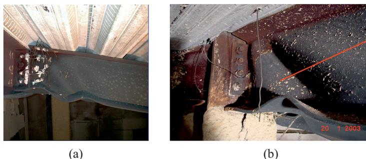
Figura 4.22: Encurvadura local na extremidade do perfil de aço de uma viga mista restringida ao alongamento axial (Testes de Cardington).
