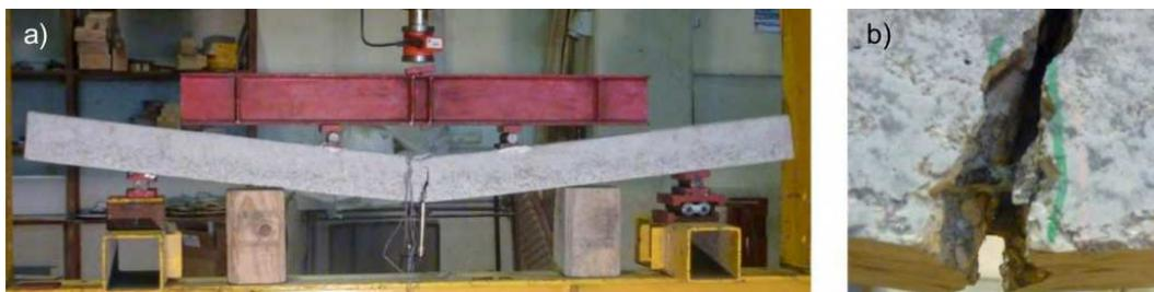
Figura 5.17: a) Vista geral da rotura da viga VA; b) pormenor da rotura longitudinal inferior. (Adaptado de [20]).
