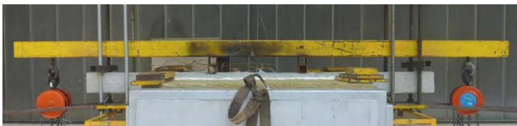
Figura 5.26: Pormenor da viga de distribuição de carga. (Adaptado de [20]).
