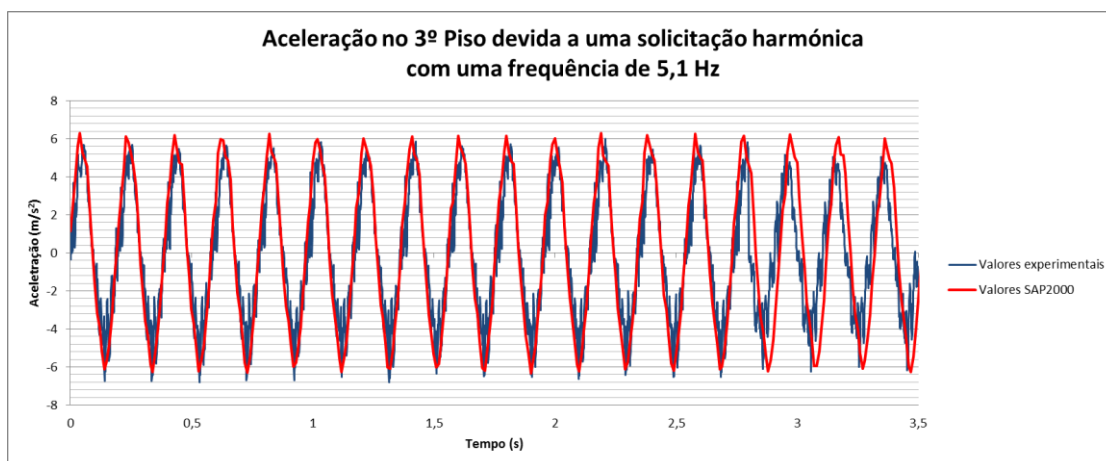
FIGURA 6-14 - ACELERAÇÕES NO 3º PISO DEVIDO A UMA SOLICITAÇÃO HARMÓNICA COM UMA FREQUÊNCIA DE 5,1 HZ
